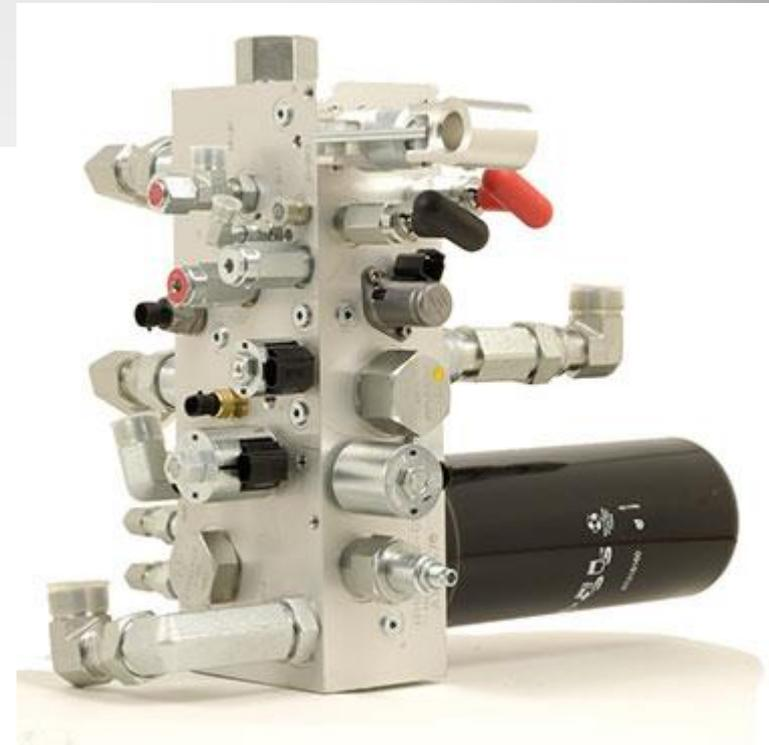
**Несколько функций управления могут быть объединены в один блок с использованием многофункциональных клапанных картриджей. (Гидрозамки, обратные, предохранительные, электромагнитные клапаны, дроссели).**
